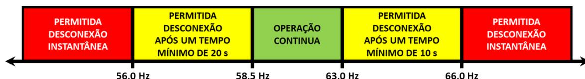
Figura 1 – Faixas de operação da central geradora hidroelétrica em regime de frequência não nominal.
