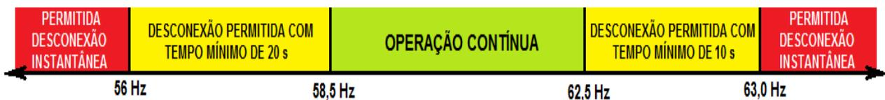
Figura 5 - Faixas de operação da central geradora em regime de frequência não nominal.
